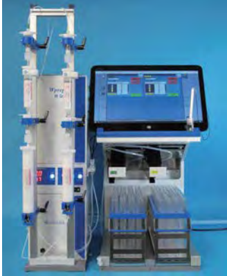
YAMAZEN 듀얼 채널 MPLC (두 명이 함께 사용 가능) W-Prep2XY
